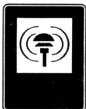
Пункт извеще- ния о пожаре
