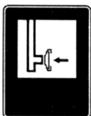
Пожарный сухотрубный стояк
