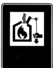
Органы управления систем дымо- и теплоудаления
