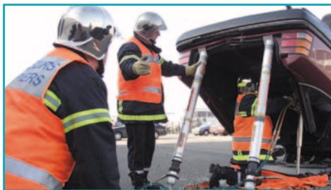
С помощью домкрата создано необходимое свободное рабочее пространство. Страховочные опоры (крепь) теперь необходимо постоянно регулировать, чтобы обеспечивать оптимальную устойчивость автомобиля.
