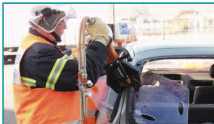
Продолжить демонтаж крыши, разрезая задние опорные стойки С.
