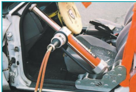
Установите домкрат в необходимое положение и зафиксируйте его на месте небольшим давлением. Это предотвратит падение приборной панели из-за последующих операций резания. Положение рукоятки управления домкрата должно быть наружу из салона и не вверх.
