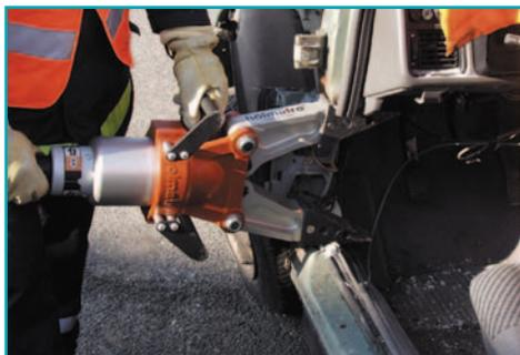
Рабочие наконечники расширителя необходимо установить в вырезанном для доступа секторе, после чего можно начать операцию подъема приборной панели автомобиля.
