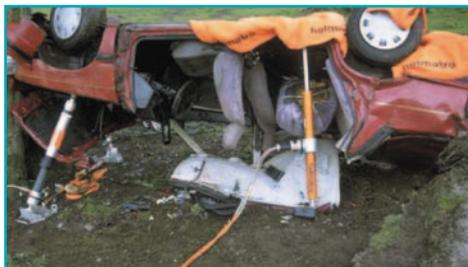
Технологии создания пространства могут применяться для различных целей, как по созданию свободной рабочей зоны, так и для обеспечения безопасной эвакуации пострадавших, зажатых в автомобиле.
