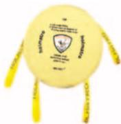
Где возможно, следует избегать направлений и путей разворачивания подушек безопасности. Если в Вашем арсенале есть защитный чехол подушки безопасности водителя, установить его теперь.
