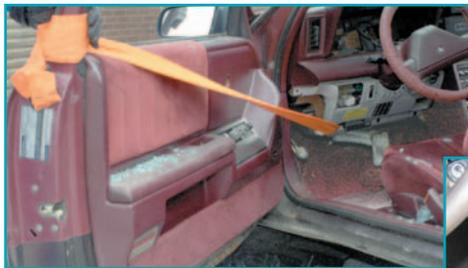
В некоторых ситуациях может также стать возможным отвод педалей от ног пострадавшего в сторону, отгнув их вбок с помощью ремней. Как видно на рисунке, дверь автомобиля может быть использована как рычаг для закреплени я ремня.
