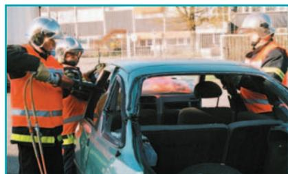
Надежно поддерживая крышу автомобиля, выполнить заключительную операцию резания, убедившись, что отсутствуют любые другие соединительные точки и связи, такие как ремни безопасности или детали пластиковой отделки.
