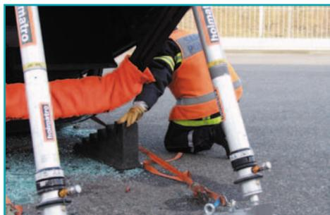
Если Вы намерены откинуть крышу автомобиля вниз, то необходимо предварительно вынуть опорные блоки, установленные под ней. Если это невозможно, продолжите выполнение работ с опорными элементами на прежних местах, чтобы предотвратить движение крыши вниз.
