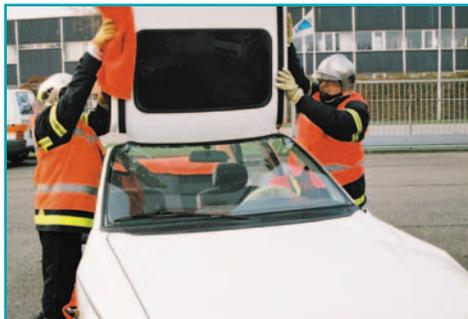
Теперь спасатели могут отогнуть крышу автомобиля вперед. Может быть необходимым использование лома в качестве рычага (оси) для перегиба.
