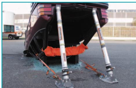
Подпереть заднюю часть автомобиля, нагрузив страховочные опоры (крепь).
