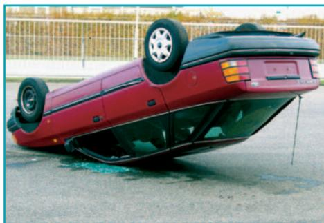
Необходимо надежно зафиксировать положение автомобиля клиньями и блоками, как указывалось ранее. Следует помнить о том, что автомобиль, показанный на рисунках этого раздела, имеет двигатель, расположенный спереди. К автомобилям с задним расположением двигателя должен быть иной подход. Если Вы имеете защитный чехол подушки безопасности – установите его сейчас.
