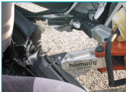
Продолжать расширение, раздвигая рабочие наконечники спреда вплоть до отделения средней стойки В от порога автомобиля или до создания достаточного свободного пространства, чтобы завершить операцию с помощью резака.
