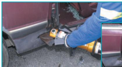
Выполнить глубокий рельефный рез в основании средней стойки В. При необходимости для облегчения резания следует сначала сдавить эту область с помощью
