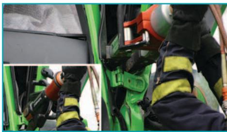
Удалите дверь грузового автомобиля, где возможно применяя технику раскрытия петель. Начав со стороны, где расположены петли, можно обнаружить, что дверь легко удаляется после срезания или разрушения петель.
