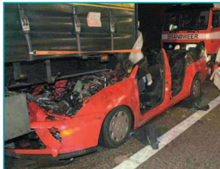
Проведение аварийно-спасательных работ может нарушить стабилизацию и устойчивость объектов. По этой причине она (устойчивость) должна непрерывно контролироваться в течение процесса эвакуации. Крепежные устройства могут облегчить усилия по обеспечению устойчивости.
