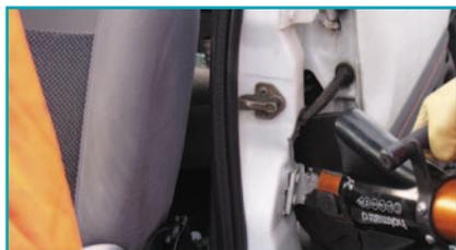
Затем следует снять заднюю дверь с помощью резания или разжима дверных петель.
