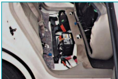
Некоторые производители используют специальное устройство, которое автоматически отключает аккумуляторную батарею в случае столкновения.
