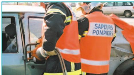
После удаления дверных петель и ограничителя между ними следующим шагом является снятие двери с замковой части.
