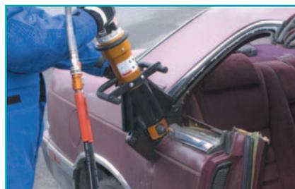
Выполнить вертикальный рельефный разрез перед задней стойкой С.
