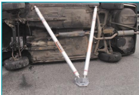
Подпереть днище автомобиля механическими распорками (из дерева или металла), или использовать гидравлические или пневматические стойки (крепь).
