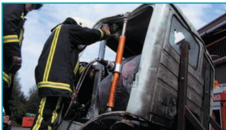
При необходимости Вы можете поднять крышу грузового автомобиля вверх, сделав профильные надрезы с обеих сторон крыши и выдавливая ее с помощью домкрата.
