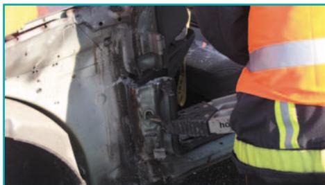
Зажать расширителем вырезанный кусок секции.
