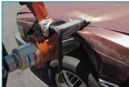
сжатие / разламывание крыла
