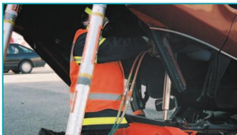
В зависимости от выбранного метода, в данный момент Вы либо приподнимаете автомобиль вверх, либо толкаете его крышу вниз, применяя домкрат.
