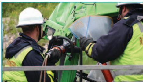
Обрежьте переднюю стойку А кабины грузового автомобиля вверх и ослабьте ее, надрезав стойку А в основании, а также переднюю панель в области приборной доски для независимого отгиба панели вперед.
