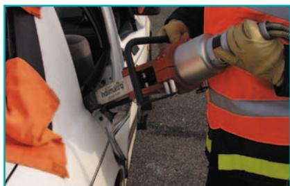
Теперь следует отжимать дверь вплоть до разрушения замка и раскрытия двери.
