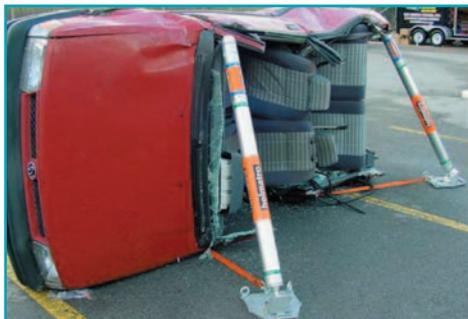
В зависимости от конкретной ситуации, может потребоваться также использование распорок и крепи для стабилизации автомобиля со стороны крыши.
