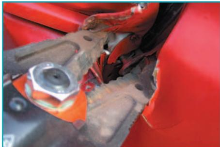
комбинированный инструмент при отрыве замка
