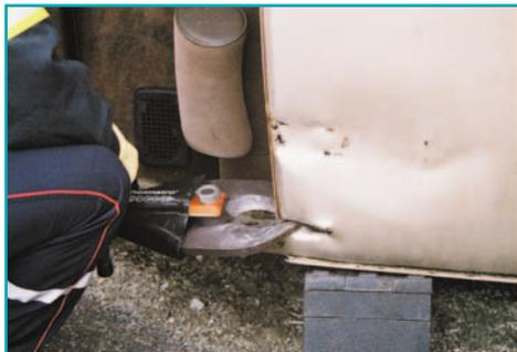
Выполнить профильный надрез крыши автомобиля непосредственно над задней стойкой С. На некоторых типах легковых автомобилей конструкция крыши такова, что потребуются также разрез крыши и над передней стойкой А.
