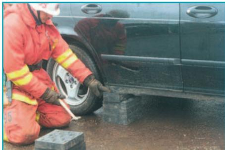
После завершения полного осмотра автомобиля и определения источников опасности автомобиль должен быть стабилизирован (устойчиво закреплен). Более подробно это будет рассмотрено в разделе "Стабилизация" данной книги.
