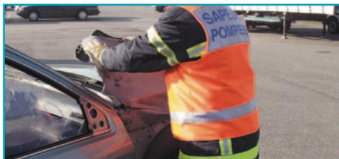
Теперь обшивку можно удалить с помощью спредера. При расширении (т.е. снятии) крыла следует соблюдать осторожность, так как оно может неожиданно отскочить от корпуса автомобиля.
