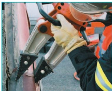
Сдавите пороги автомобиля, чтобы создать пространство, необходимое для наконечников расширителя.
