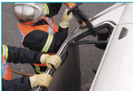
Отрезать заднюю стойку С максимально близко к крыше автомобиля.
