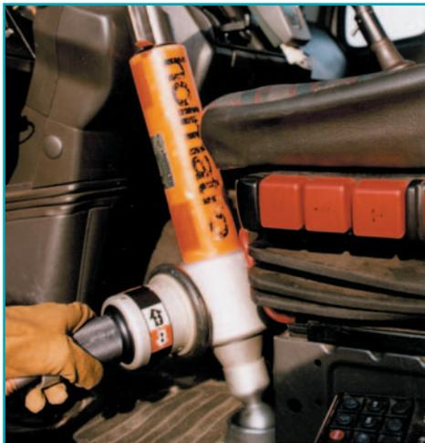
Во многих случаях значительную помощь окажет наклон или выталкивание рулевой колонки вверх. Это часто можно сделать, используя штатную систему регулировки наклона рулевого колеса автомобиля или, если необходимо, путем сдвига рулевой колонки аварийно-спасательным инструментом.
