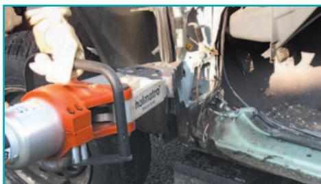
Отгнуть эту секцию наружу с помощью расширителя.
