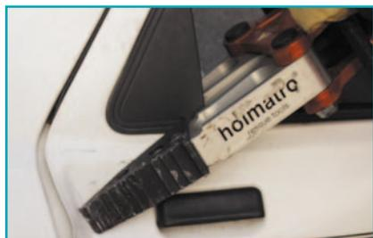
Начав с задней стороны, сдвинуть дверь, чтобы создать место для введения рабочих наконечников расширителя.
