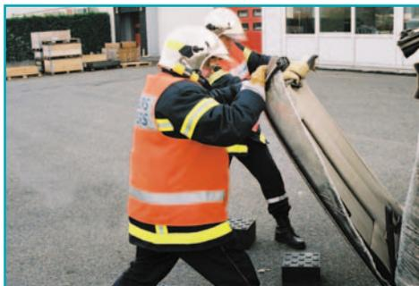
Для создания горизонтальной рабочей платформы следует поставить опорные блоки в тех местах, куда будет положена крыша автомобиля. Медленно и плавно отгибайте крышу автомобиля в направлении вниз, чтобы автомобиль не потерял устойчивости.
