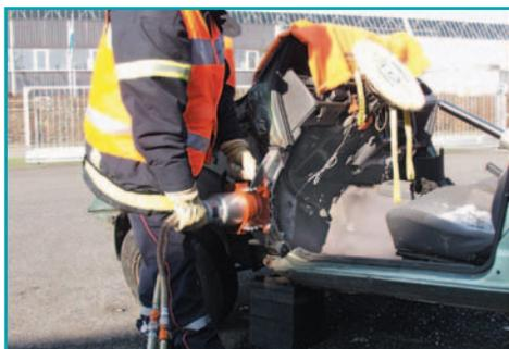
Работая одновременно с домкратом, если он установлен, медленно приподнимайте приборную панель автомобиля, постоянно оценивая надежность точек контакта рабочих наконечников расширителя и корпуса автомобиля.
