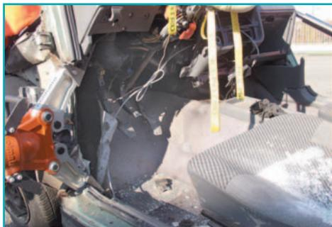
Теперь создано достаточное рабочее пространство, которое поможет безопасно эвакуировать пострадавшего. Расширитель не следует отпускать вплоть до полной эвакуации пострадавшего из автомобиля.
