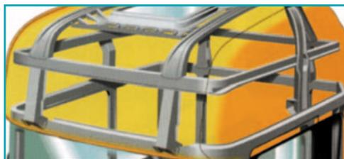
*Конструкция кабины грузового автомобиля.*
