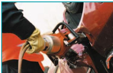
Использовать расширитель для отрыва механизма замка, отжав дверь от корпуса автомобиля наружу, и закончить операции, как описано выше.
