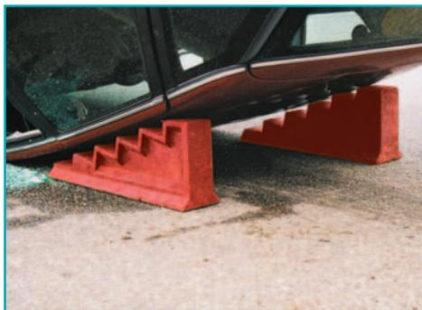
Установить опорные блоки между задней частью крыши перевернувшегося автомобиля и поверхностью земли.
