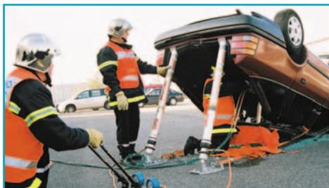
Выполнение операций резания, подъема и стабилизацию устойчивости автомобиля следует проводить полностью скоординировано.
