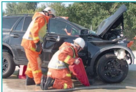
При использовании ступенчатых блоков клинья могут быть использованы для их надежной фиксации. Перевернутый ступенчатый блок может также хорошо работать.
