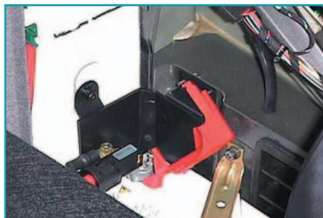
СИСТЕМА АВТОМАТИЧЕСКОГО ОТКЛЮЧЕНИЯ АКБ
