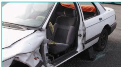
Сначала необходимо снять переднюю дверь автомобиля, используя один из описанных ранее методов.
