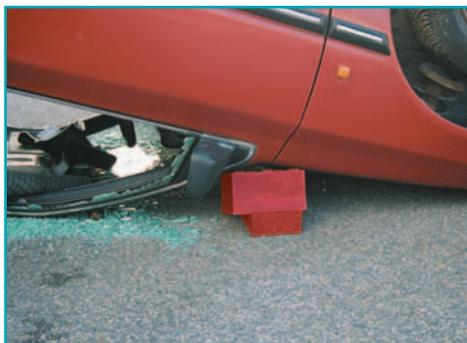
Для обеспечения хорошей устойчивости поставить дополнительные блоки в пространстве между капотом и лобовым стеклом автомобиля.
