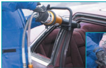
Если средняя стойка В продолжается до крыши автомобиля, то необходимо обрезать ее в самой верхней ее части.
