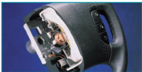
*поперечное сечение неразвернутой передней подушки безопасности*
