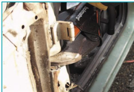
Сделать два профильных надреза на расстоянии приблизительно 30 см /12 дюймов друг от друга в основании передней стойки А.
