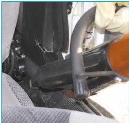
Работая со стороны задней двери автомобиля, делают глубокий рельефный рез в нижней части средней стойки В с целью ее ослабления.
