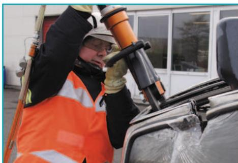
Отрезать среднюю стойку В ближе к крыше автомобиля.
