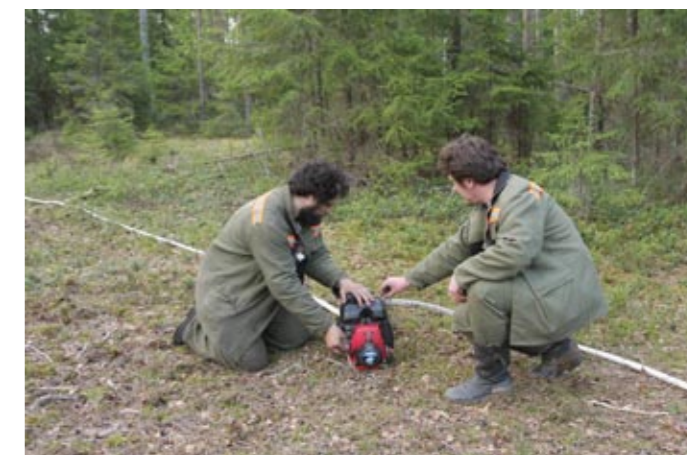
Последовательная установка мотопомп «в линию» при подаче воды на большое расстояние
