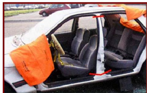
Средняя стойка перекусывается в двух местах (вверху и внизу). Производится перерезание передних и задних стоек, демонтаж крыши.
