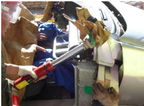
Перемещение передней панели автомобиля осуществляется для облегчения эвакуации пострадавших или получения доступа к их ногам. Для этого вставляется дополнительный упор из подкладок под центральную стойку в то место, куда будет направлено усилие от нижнего упора гидроцилиндра.
