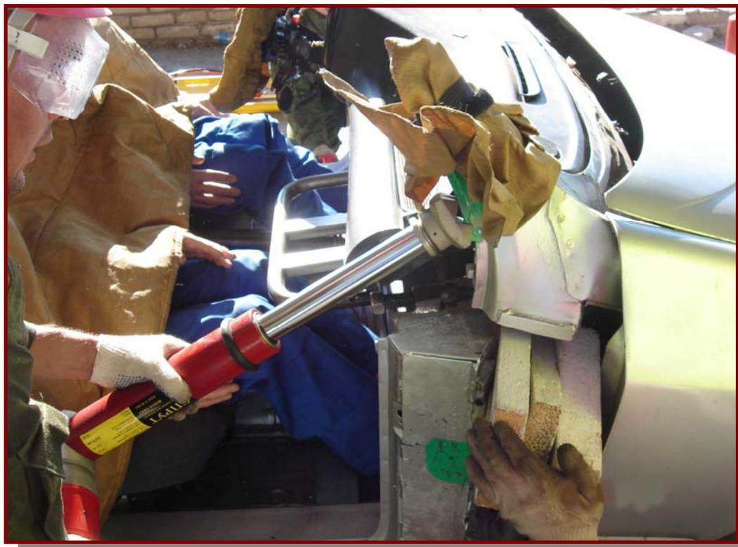
Рис. 8. Установка защиты на острые края и кромки.
