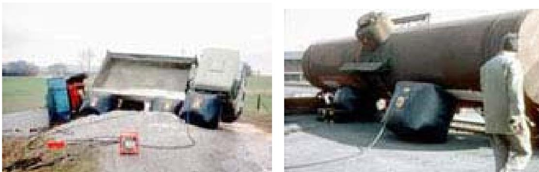
Пневматические подушки низкого давления для подъема тяжелых грузов могут устанавливаться под объекты, имеющие зазор над поверхностью земли всего в 50 мм.
