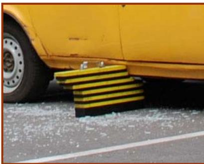
ТС остались на полотне дороги с опорой на все колеса, поэтому для стабилизации ТС необходимо установить опорные блоки и подложить клинья под колеса.
