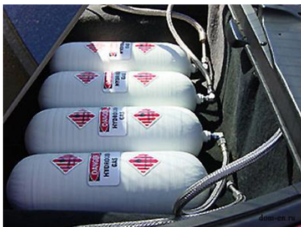
Размещение резервуаров с гидридом.
