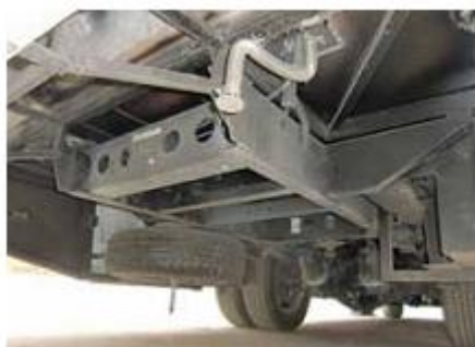
Конструкция автобуса рамная
