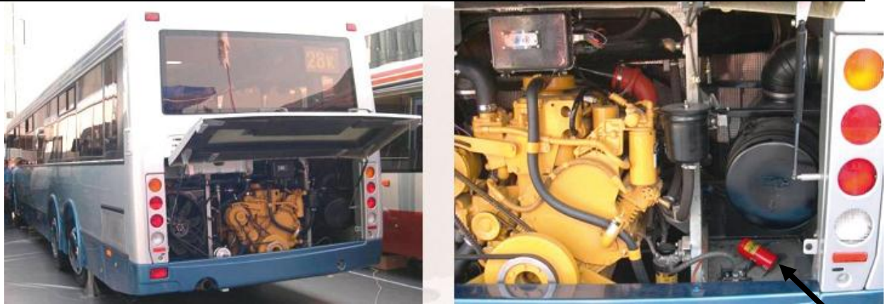
Системы автоматического пожаротушения на автобусах «ЛиАЗ-5256»
