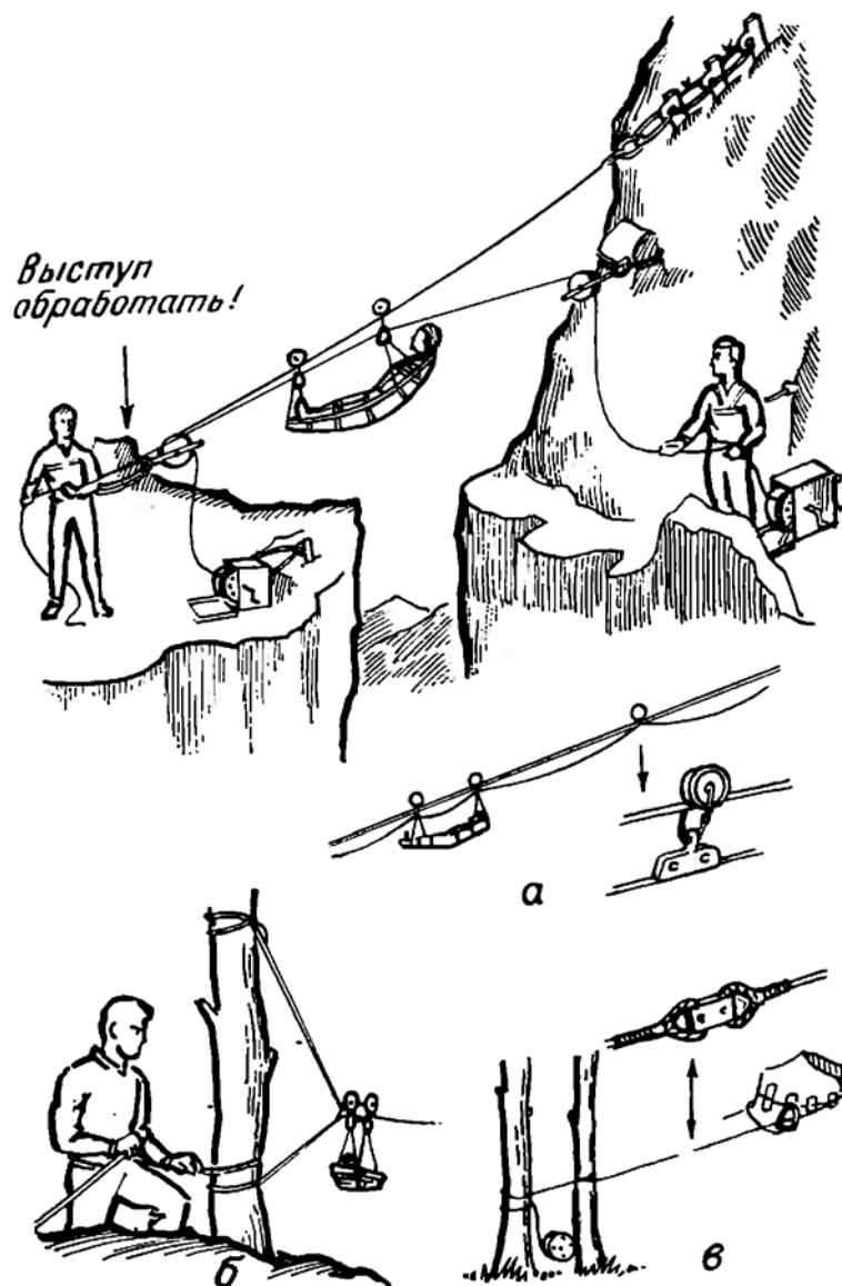
Рис. 17. Транспортировка по подвесной дороге: а — с помощью блок-тормоза; б и в — с помощью подручных средств
