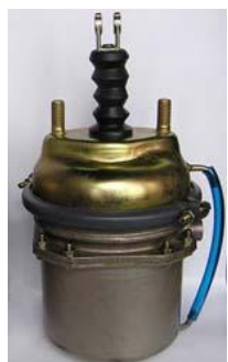
Тормозная камера Рабочей тормозной системы с энергоаккумулятором
