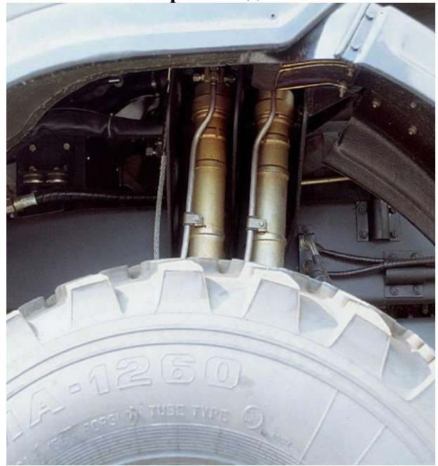
Подвеска с гидропневматическими стойками
