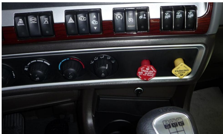
Желтая кнопка - стояночный тормоз
