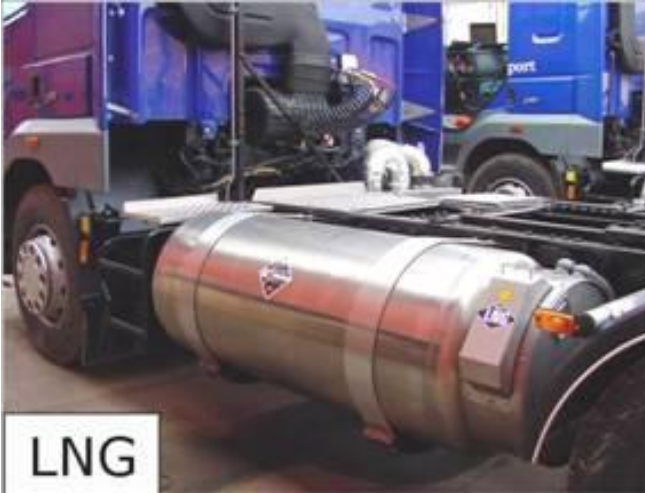
Расположение газобаллоного оборудования на грузовиках
