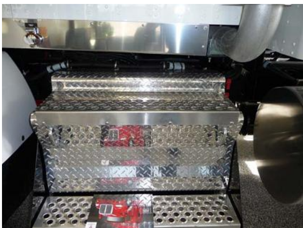
Аккумулятор расположен под ступенькой кабины
