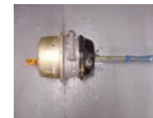
Тормозная камера стояночной тормозной системы
