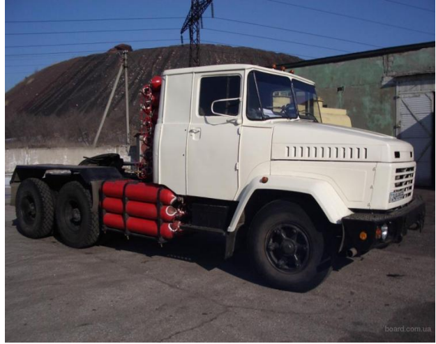
Расположение газобаллоного оборудования на грузовиках
