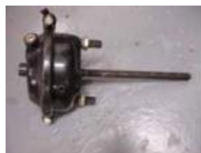
Тормозная камера рабочей тормозной системы без энергоаккумулятора
